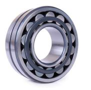
调心滚子轴承是双列不可分离轴承。包括有球面滚道的 实体外圈、圆柱孔实体内圈和带保持架的鼓形滚子。 内圈为圆柱孔。对称的鼓形滚子可以在外圈球面滚道里 自由调整,这样可以补偿不对中和齿形偏差。
